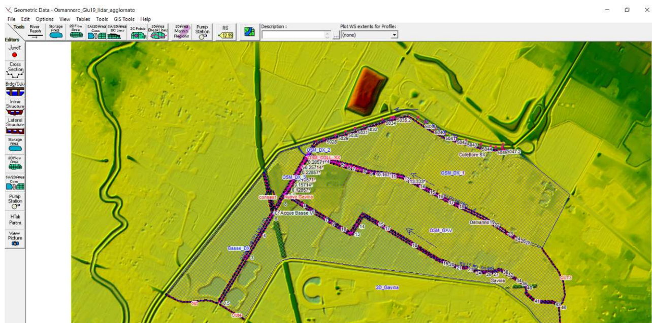
Figura 14 – Schematizzazione modello idraulico comparto Osmannoro
