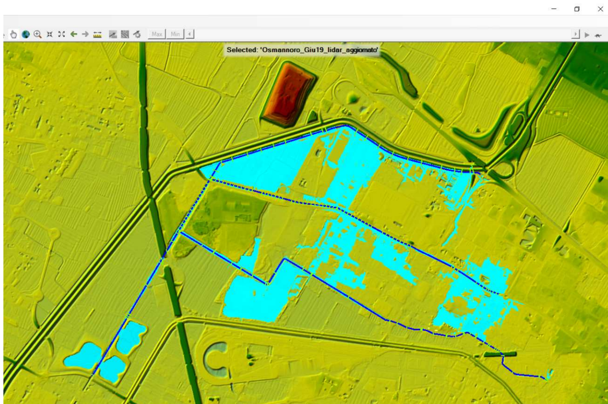
Figura 15 – Risultati verifiche idrauliche Tr 30 anni
